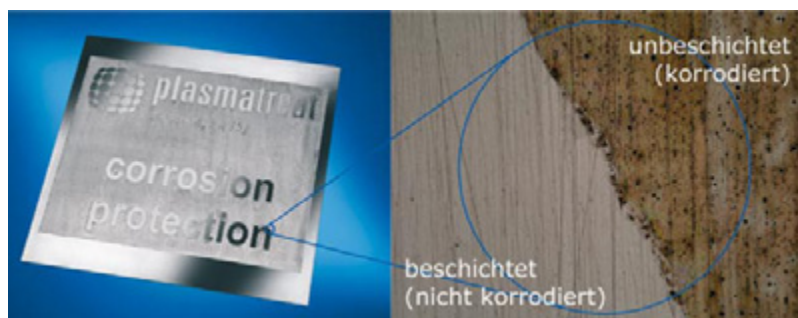
Bild 8: Demonstration der selektiven Wirkung einer Plasmapolymerschicht: ein mit Logo und Schrift beschichtetes Aluminiumblech nach 96 Stunden Salzsprühnebeltest
