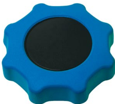
Bild 7: Verstellrad von Müller Technik: erst die Vorbehandlung mit Openair Plasma ermöglicht den festen Verbund eines harten Polypropylens (innen) und einer weichen, griffigen TPU-Spritzguss-Ummantelung
