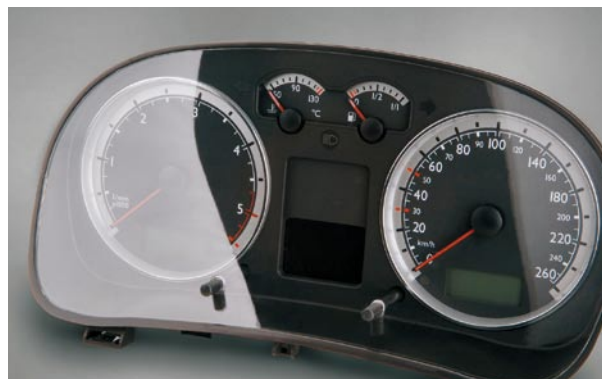
Bild 6: Nach dem Spritzgießen, aber vor dem Lackieren von Cockpitmodulgehäusen erfolgt die mikrofeine Reinigung mit atmosphärischem Plasma
