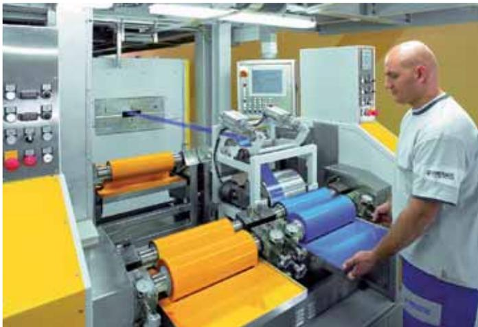
In der neuen 49 m langen Griesser Coil Coating Anlage wurde durch den Einsatz von Plasma auf die Verwendung von Nasschemikalien im Vorreinigungsprozess komplett verzichtet.
