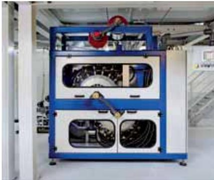
**Weltweit einzigartig ist der Einsatz von Plasma im Coil Coating Prozess. Die nur 2 x 1,5 m große Plasmaanlage ersetzt eine 21 m lange Reinigungsstraße.**
