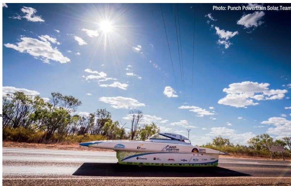
Fig 1 - Powered only by the sun: the energy-efficient Punch One solar car at the World Solar Challenge rally in Australia. The plasma bonding process reduced the weight of the CFRP body by several kilos Solo con l'energia solare: la Punch One, ad efficienza energetica, al World Solar Challenge rally in Australia. Il processo di incollaggio al plasma ha ridotto il peso della carrozzeria in CFRP di alcuni chili
