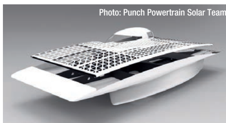
Fig 4 - Assembly of the different car body layers Assemblaggio dei vari strati della carrozzeria
